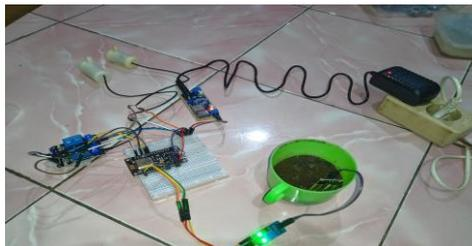
**Gambar 1.6 Pengujian Alat dengan Media Tanah**
