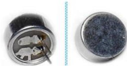
**Gambar 3.13 Bentuk Fisik *Microphone Condenser***
